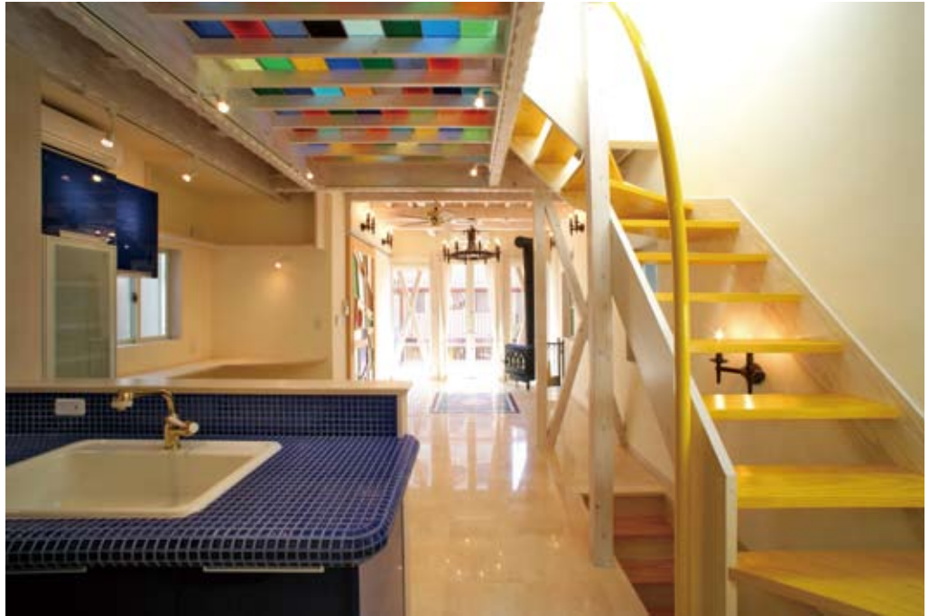
2階LDK。ダイニング上部に架かるガラスの廊下は、スタンドガラスの原材料を原価で仕入れたものを使用。床はホテルで未使用となった規格外の大大理石を格安で入手した。キッチンは既製品の天板を購入せず、合板+タイル仕上げでオリジナルキッチンに仕立て直している
